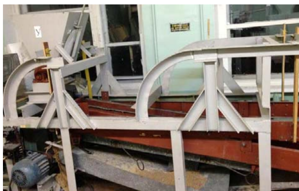
Рис. 1- Экспериментальная установка «Одноярусный трехрешетный стан».
