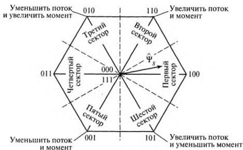
Рис. 4 – Пример набора векторов напряжения с вектором потокосцепления, расположенным в 1-ом секторе
