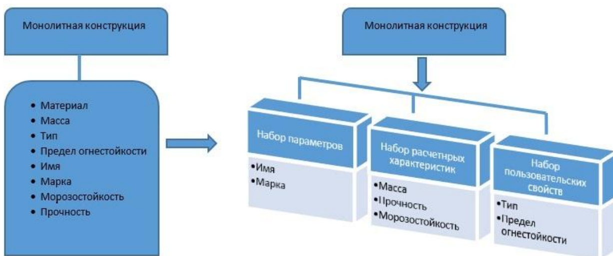
Рис. 2. – Методология формирования информационного моделирования при создании технического задания по выполнению монолитных конструкций объекта капитального строительства.
