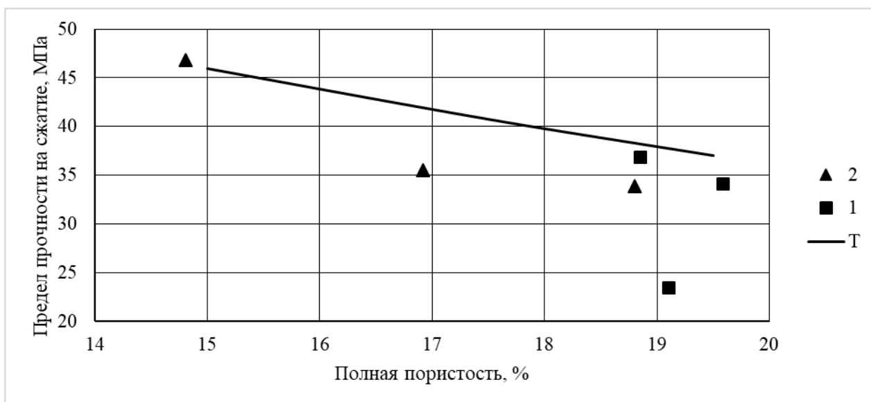
Рис. 2. Зависимость предела прочности на сжатие от полной пористости бетона 2,1 – соответственно по двух (раздельное бетонирование) и одностадийной (эталонной) технологии центрифугирования.
