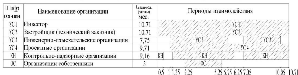
Рис. 2. – Организационно-управленческая модель рационального совмещения процедур на этапах предпроектной и проектной подготовки объекта к строительству (линейная форма)
