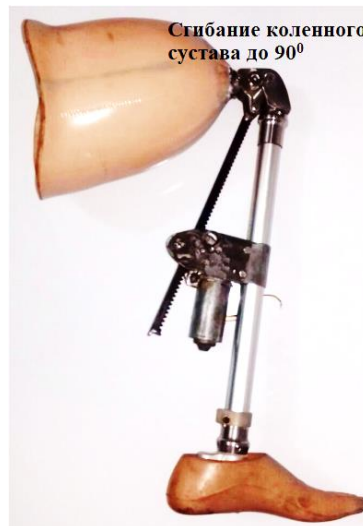
Рис. 3. - Сгибание/разгибание до 90 градусов модели коленного сустава.
