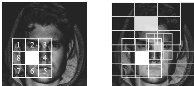
Рис. 4. – «Слабый» классификатор, вычисляемый с помощью признака MB-LBP и стадия комбинации «слабых» классификаторов Общий алгоритм обнаружения лиц работает следующим образом (рис. 5):
