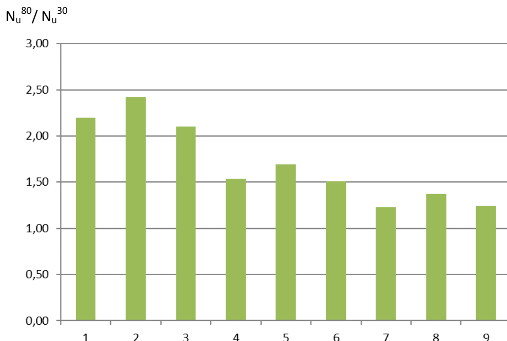
Рис.5 – Отношение несущей способности колонн из бетона класса В80 и В30
