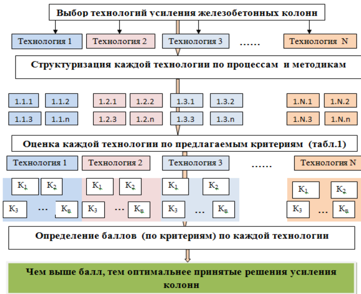
Рис. 2. — Алгоритм вариантного формирования организационно-технологических решений усиления колонн при реконструкции зданий и сооружений
