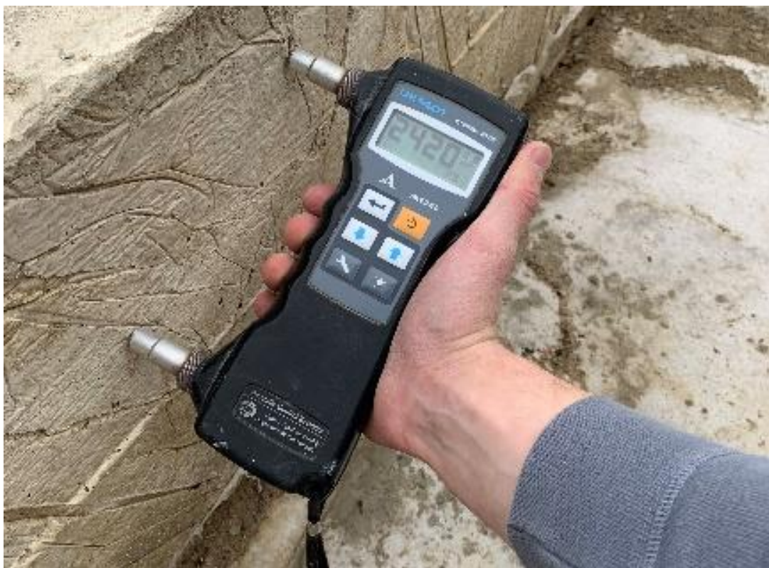
Рис. 1. Испытание бетона на прочность ультразвуковым методом
