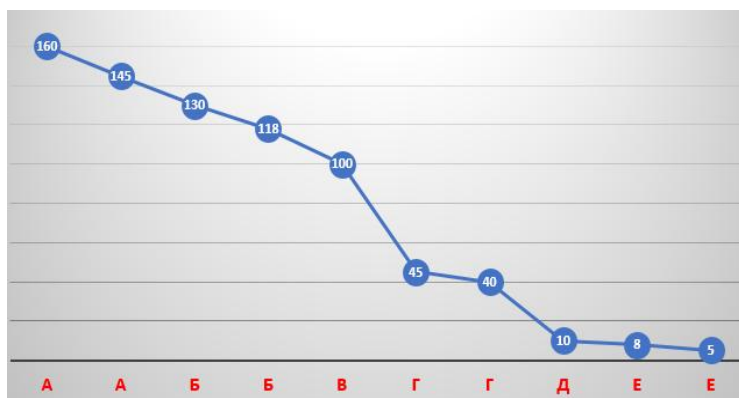
Рис. 5. – Максимальные и минимальные значения удельной трудоемкости монтажных процессов в зависимости от степени укрупнения конструкций: а, б – поэлементный монтаж; в, г – укрупненными плоскими элементами; д, е – объемными блоками, по данным [6]
