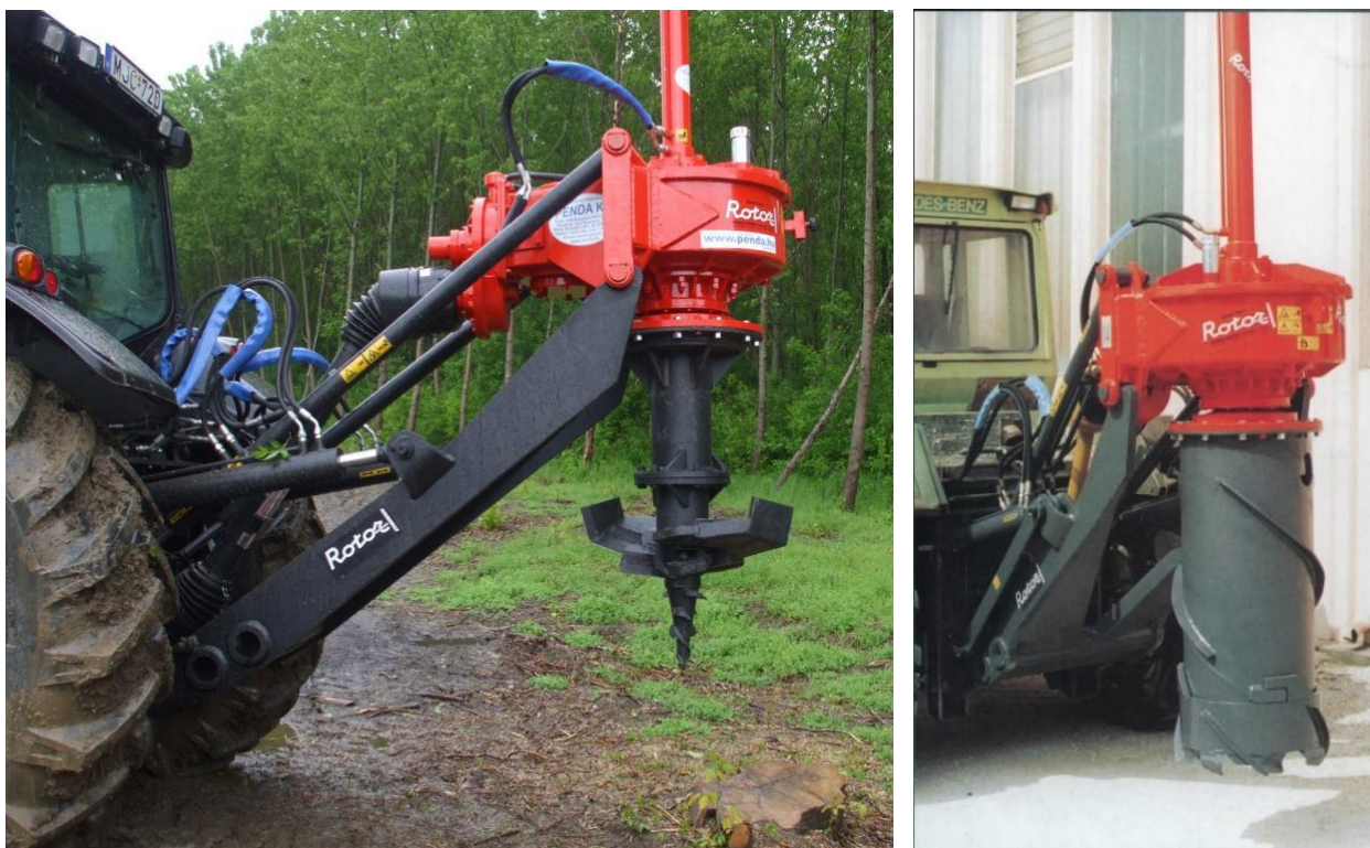
Рис. 1 - Корчеватель пней [9] FERRI ROTOR SPEEDY 80-100
