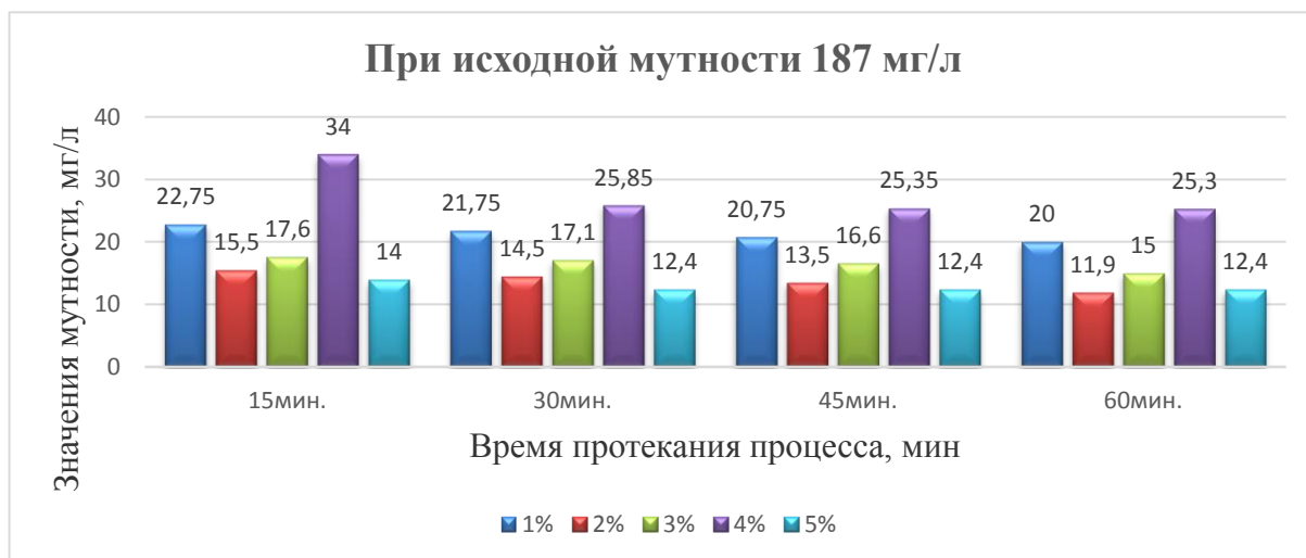
Рис.3. Зависимость степени осветления от продолжительности и различных доз коагулянта и полиакриламида
