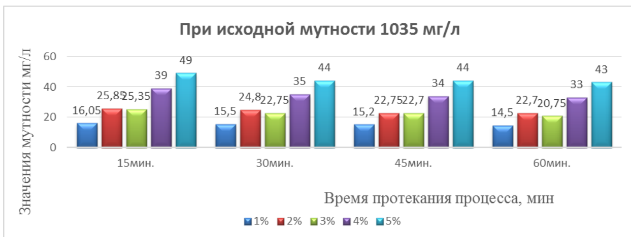
Рис.4. Зависимость степени осветления от продолжительности и различных доз коагулянта и полиакриламида
