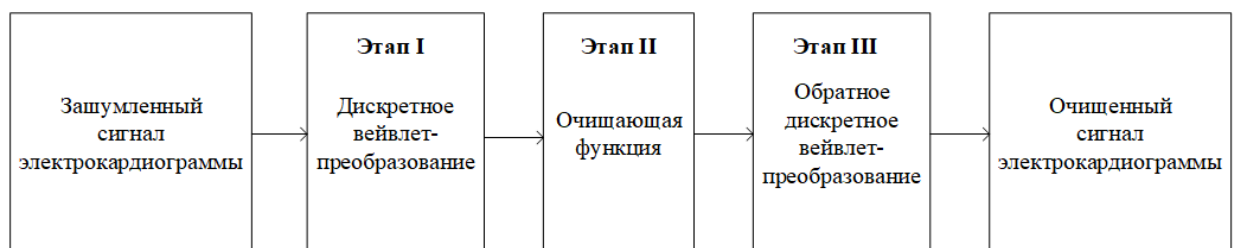
Рис. 3. – Этапы очистки сигналов электрокардиограмм от шума
