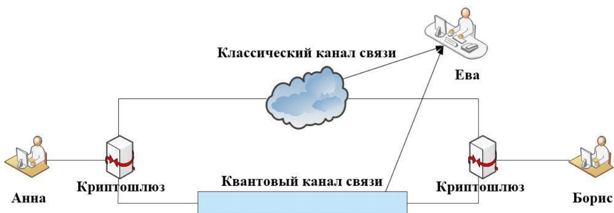
Рис. 1. Сеть для квантового распределения ключей.
