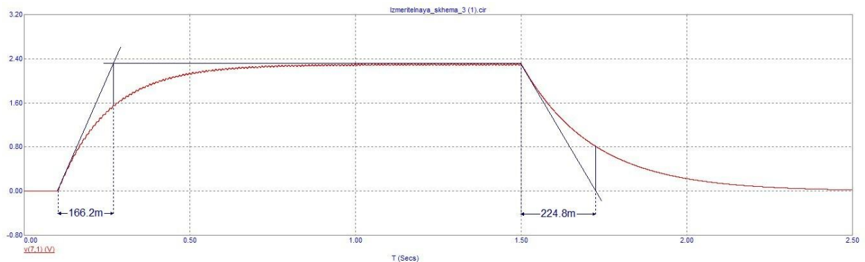
Рисунок 3. Результаты моделирования времени переходного процесса на выходе измерительной схемы
