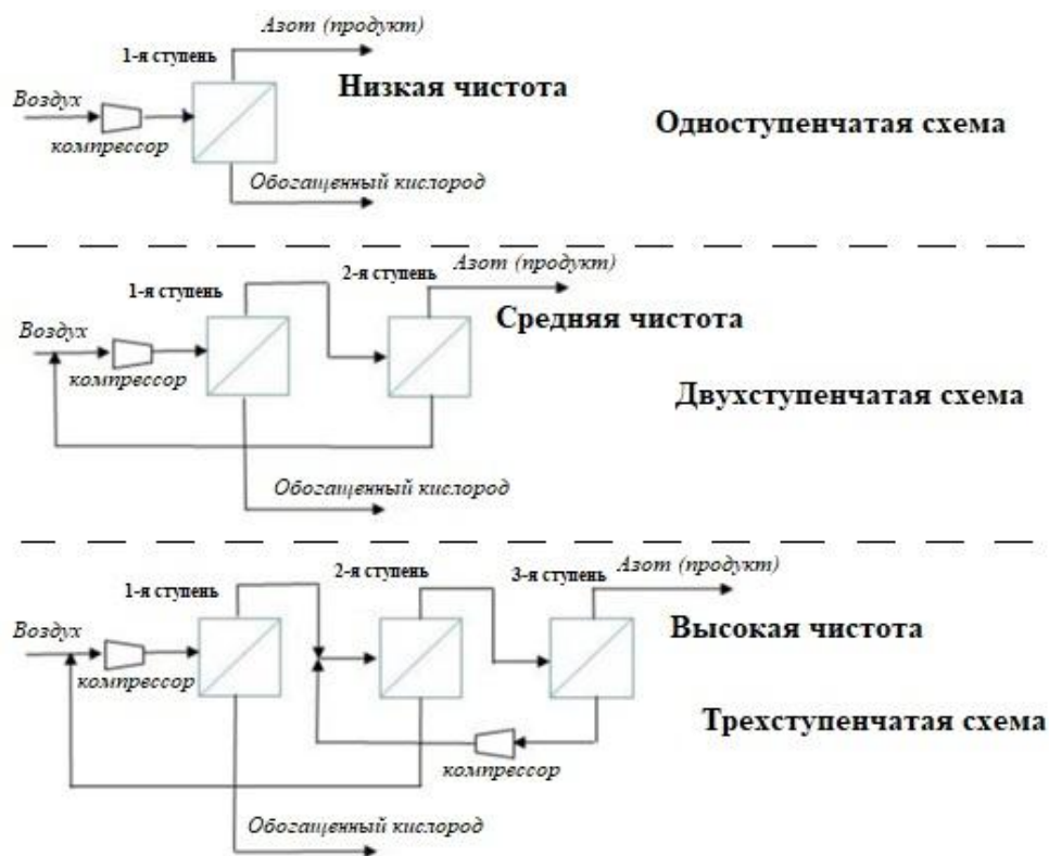
Рис. 2. – Схемы мембранного газоразделения с различной чистотой азота
