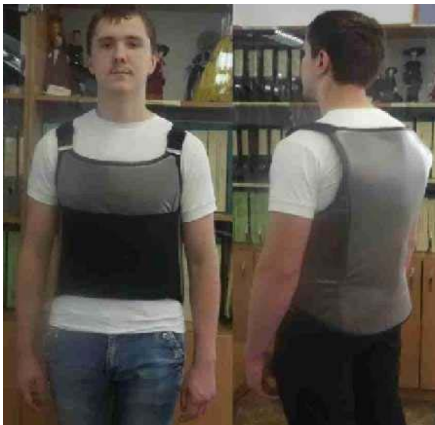
Рис.5. - Мужской виброзащитный жилет нательного ношения
