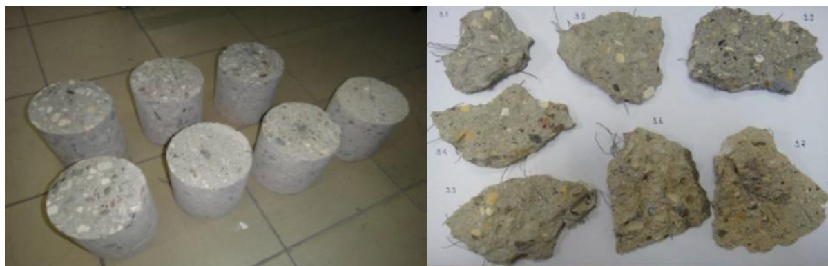
Рис. 1. – Образцы-цилиндры и фрагменты сталефибробетона, извлеченные методом отрыва со скалыванием
