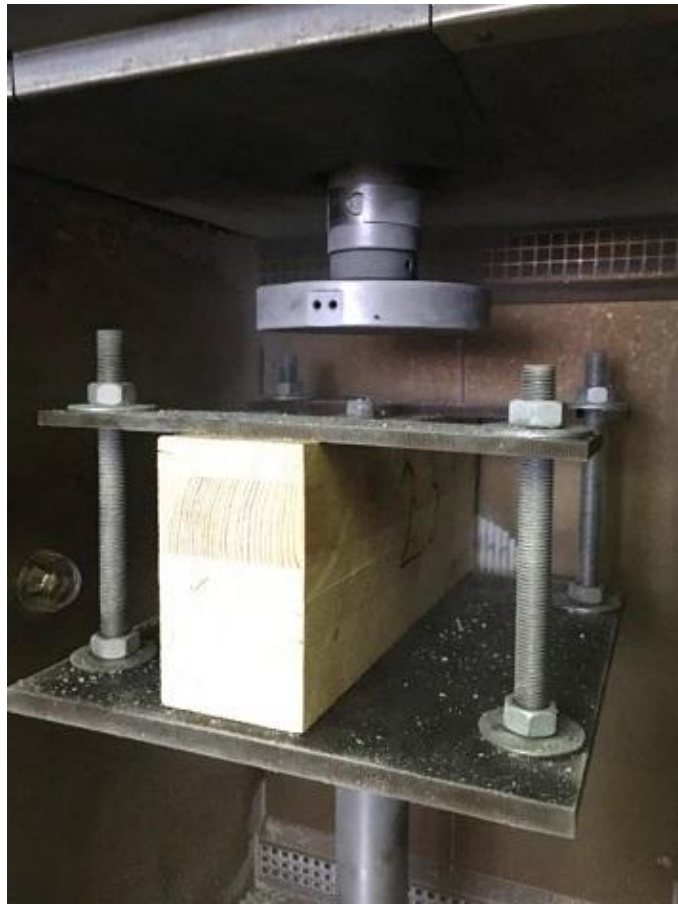
Рис. 1. Образец, установленный в испытательной температурной камере
