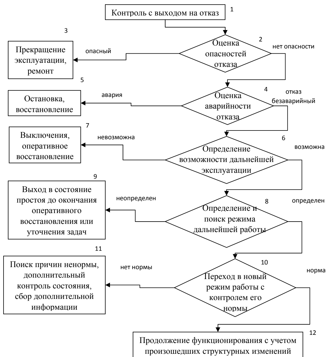
Рис.3 Блок-схема протекания процесса деградации отказа.
