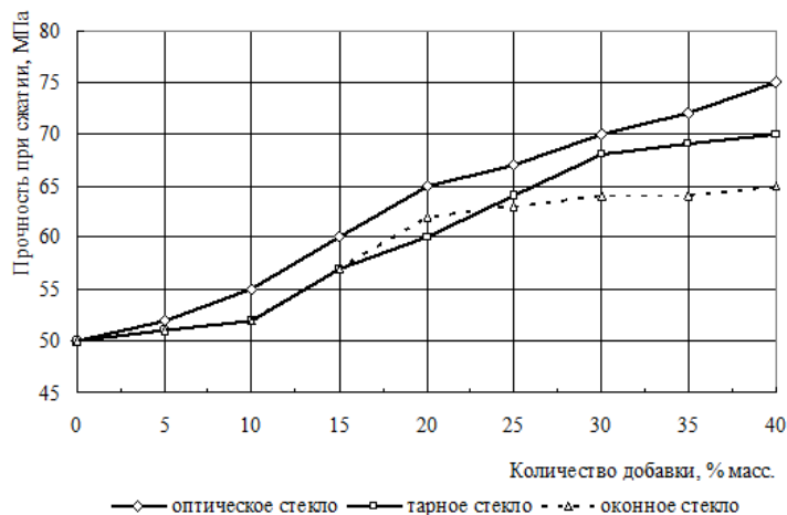
Рис.2. Влияние стекольных фритт на прочность матричного материала
