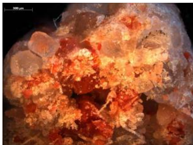
Рис. 6 – Фотография разреза гранулы товарной фракции (увеличение 50х)
