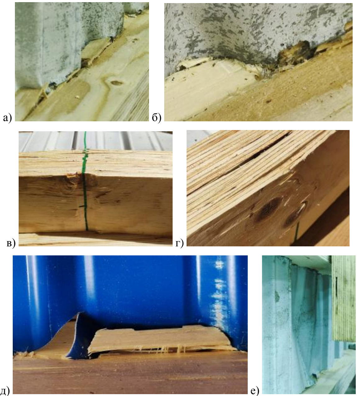
Рис. 2. – Повреждения испытываемых балок в процессе испытаний: а) скалывание древесины между зубьями, б) смятие древесины в месте контакта с зубом, в) смятие на опорах, г) разрушение при изгибе поясов, д) разрыв стали в стенке, е) потеря устойчивости стенки.
