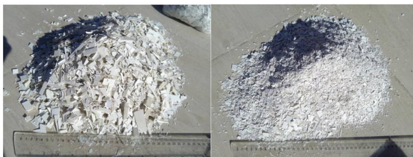
Рис. 1. – а.) ПВХ, полученный при первичном дроблении. б.) Заполнитель ПВХ, полученный путем вторичного дробления [6]
