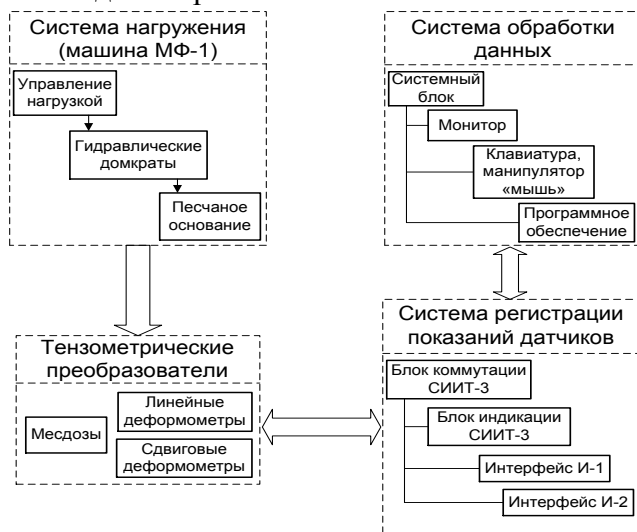
Рисунок 1 - Блок-схема программно-измерительного комплекса автоматизированной системы научных исследований (АСНИ)
